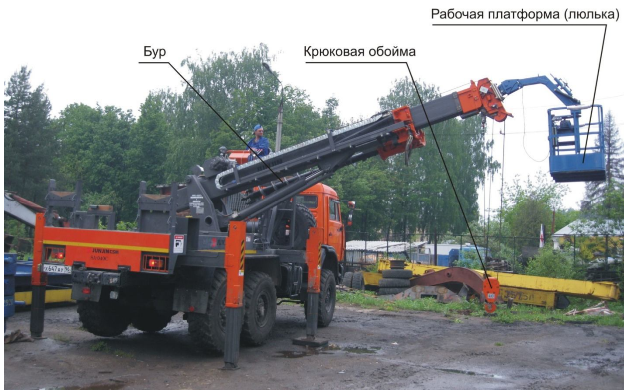
Рис.1 Кран-манипулятор с буровым оборудованием и люлькой для перемещения людей
