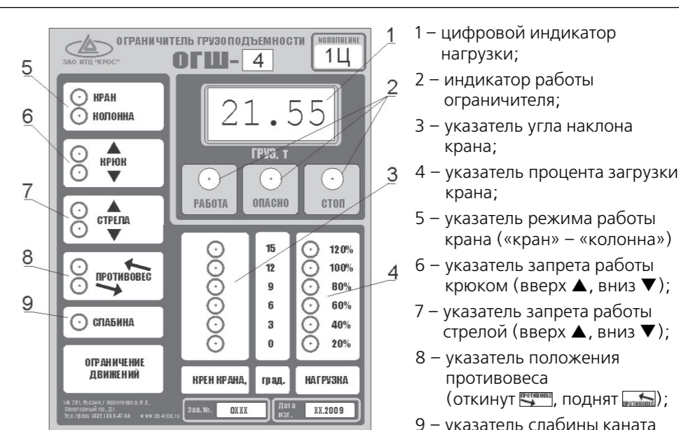
Рис. 1. Блок микропроцессорный ограничителя ОГШ-4
