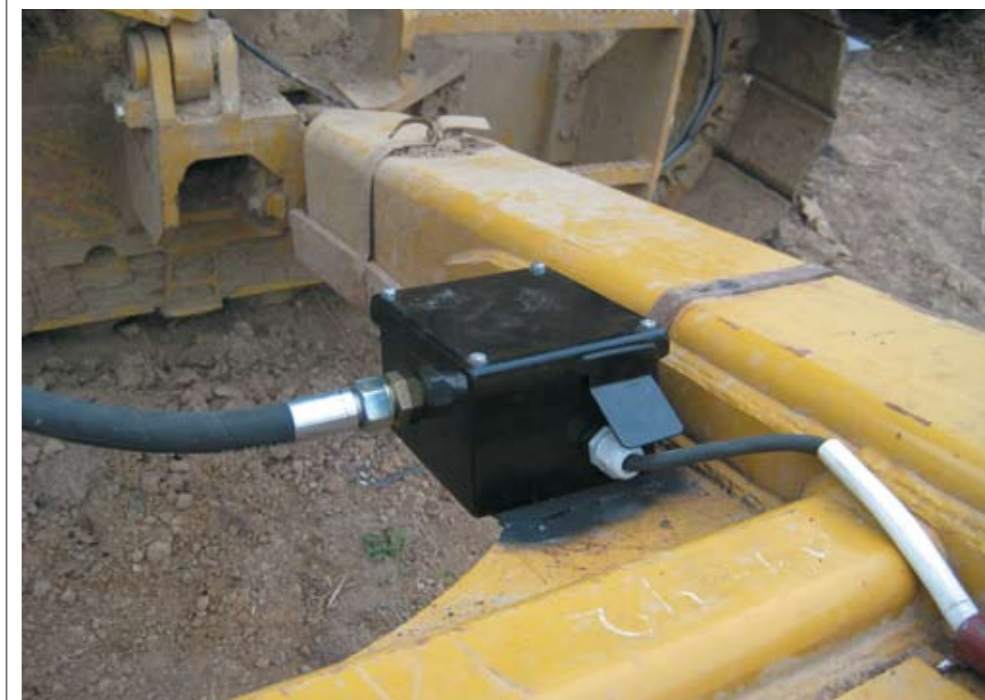
Рис. 2. Установка датчика угла наклона стрелы
