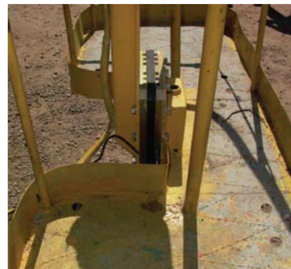
Рис. 4, 5. Примеры установки ограничителя грузоподъемности ОКМ-1 с модулем МДН
