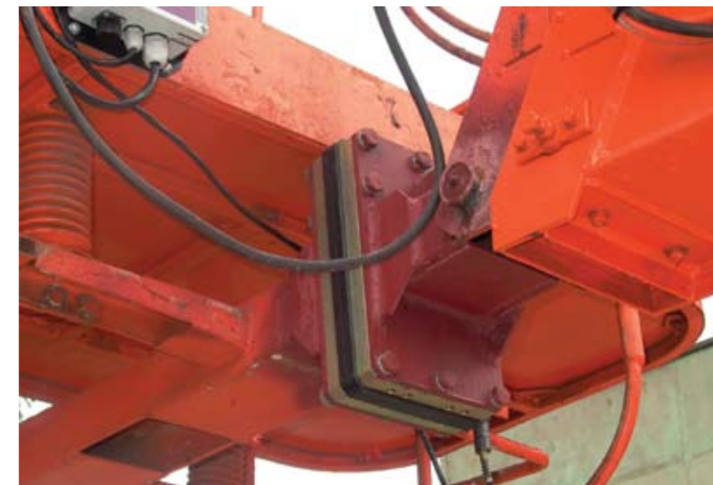
Рис. 4, 5. Примеры установки ограничителя грузоподъемности ОКМ-1 с модулем МДН
