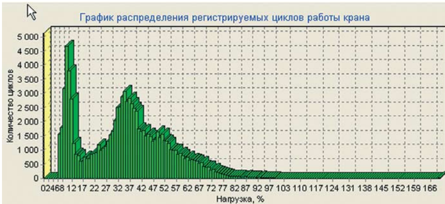
Рис. 5. Пример графика распределения регистрируемых циклов работы крана
