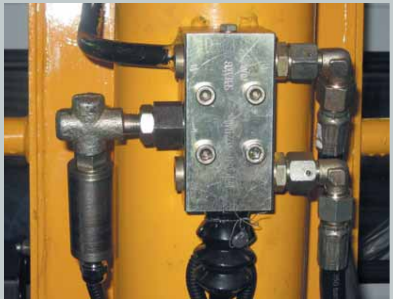
Рис. 3. Установка датчика давления Д-40 на тормозной клапан гидроцилиндра подъема стрелы
