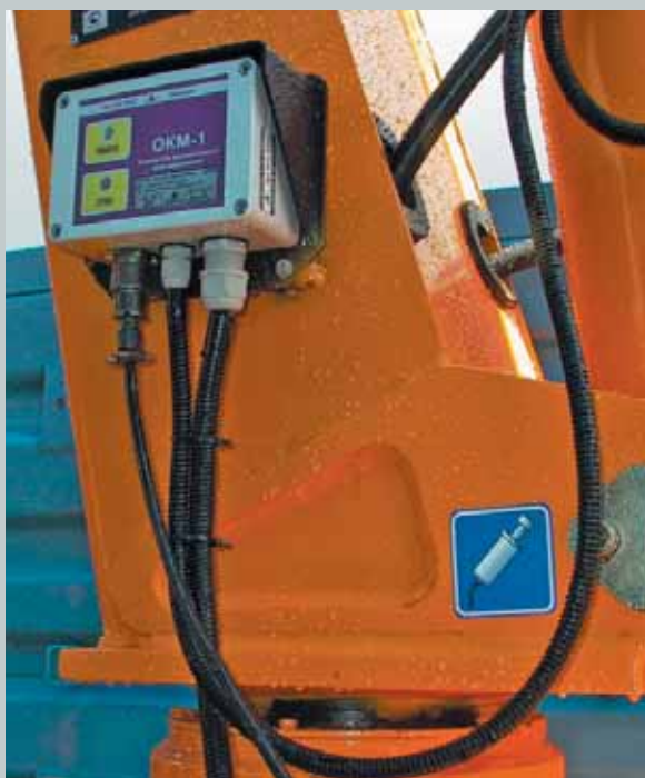
Рис. 4. Примеры установки ограничителя «ОКМ-1» на кранах-манипуляторах.
